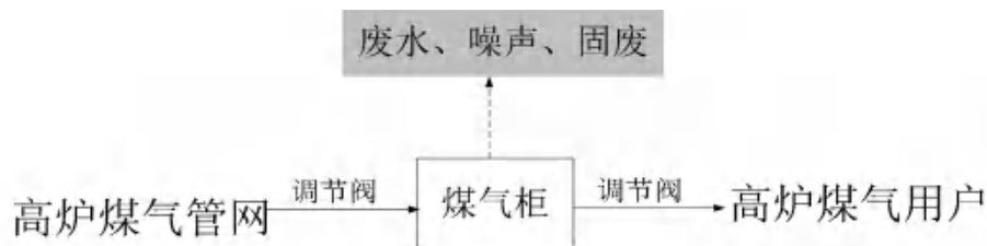
图 3.2-5 高炉煤气柜项目工艺流程及产排污节点图
