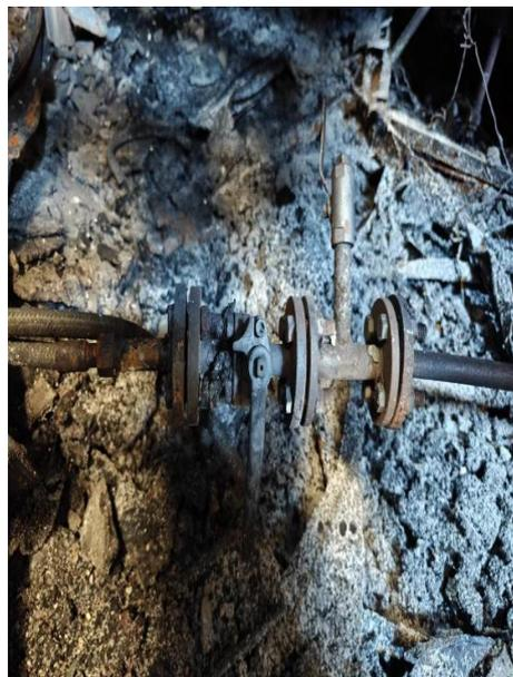
图 4-离心机氮气阀门
