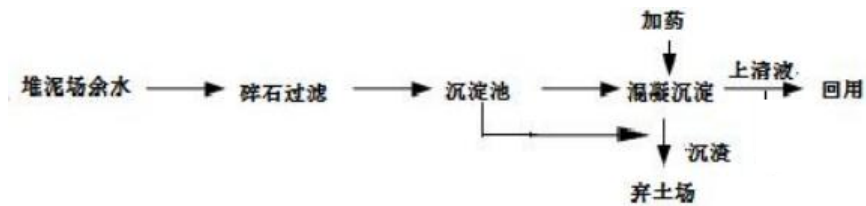
图 5-3 堆泥场余水处理工艺流程图
